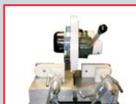
POSICIÓN DE DESCANSO PARA CORTE A 90° VERTICAL.
